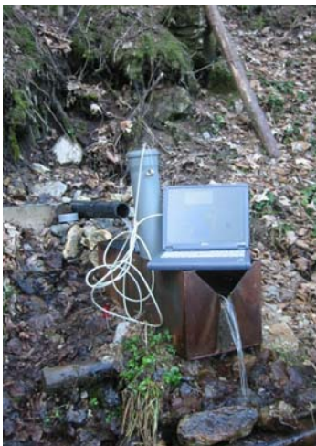
Abflussmessstation mit Datensammler im Wöllinger Graben
